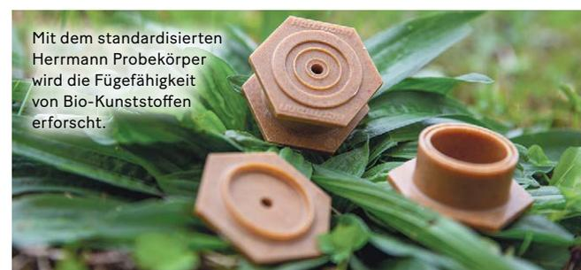
Mit dem standardisierten Herrmann Probekörper wird die Fügefähigkeit von Bio-Kunststoffen erforscht.
